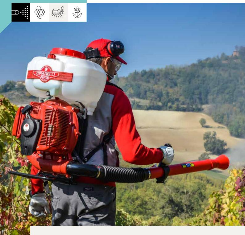
L3evo es una nueva evolución de la famosa L3, una máquina dedicada a los profesionales que garantiza larga vida y gran capacidad de trabajo. El atomizador permite tratamientos de bajo volumen. El tamaño uniforme de las gotas dispensadas, combinado con la acción del aire que mueve las hojas, permite una protección eficaz y uniforme en ambos lados de la superficie tratada
